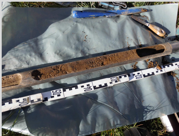
Probenahme an einer Forschungsbohrung 2018 aus dem Maare-Diatrem-Schlacken
